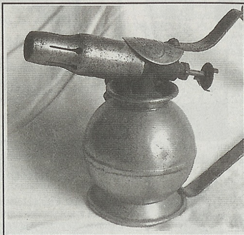
Ci-contre : lampe française "Surmelin" de 1920. A noter sa forme sphérique, qui offrait une meilleure résistance à la déformation, voire à l'éclatement sous l'effet de la pression.
